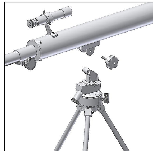
Abb. 5. Anbringen und Befestigen des Tubus.
